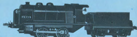
Loco OVA 20 v. alternatif, type vapeur avec tender; à renversement à main
